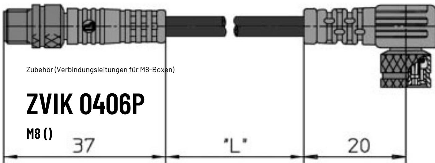
Anschluss: PUR/3 x 0,34 mm<sup>2</sup>/4 x 0,34 mm<sup>2</sup>
